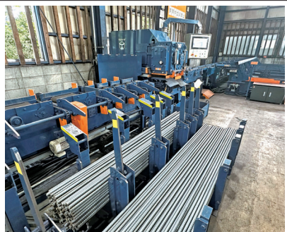
更新した鉄筋自動切断機
